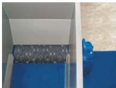
Trichter und Rotor mit 362 mm Durchmesser
