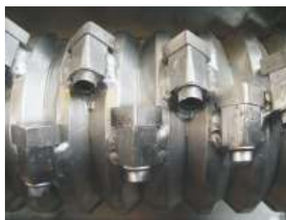
Profilrotor mit geschweißten Messerträgern (GAZ 62 S)
